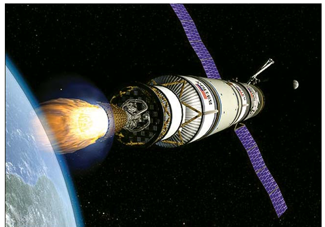
El concepto inicial de Boeing para el CEV se inclinaba por una configuración convencional de diferentes módulos en serie unidos a un vehículo de tipo cápsula. El lanzador sería uno no reutilizable de tipo Delta. (Copyright Boeing)
