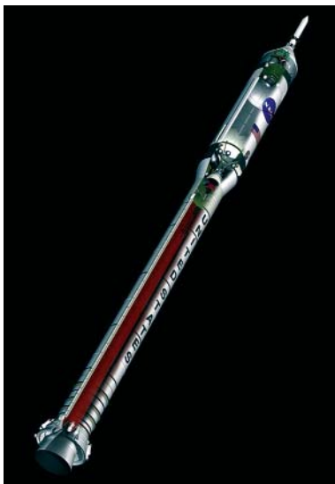
El lanzador del CEV será probablemente un derivado de los aceleradores sólidos del transbordador espacial, al que se le añadirá una etapa superior de propulsante líquido. (Copyright Alliant Techsystems Inc.)
