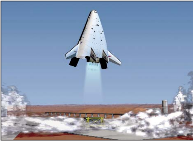
El X-33 de la NASA investigaba el concepto SSTO en busca de un considerable abaratamiento del acceso al espacio. (Copyright NASA)
